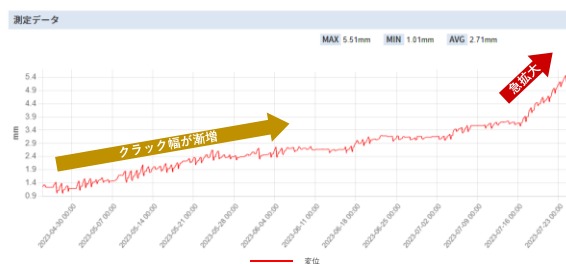
図 2.7-9. 法面のひび割れ拡大を確認
