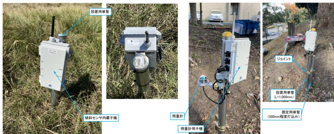
図 2.9-3. 機材の設置イメージ
