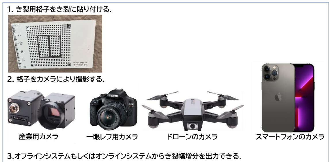
図 2.5-4. 本事例の計測作業フロー
