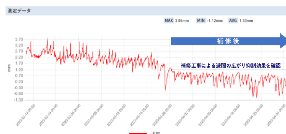
図 2.7-10. 橋梁補修工事の効果を確認
