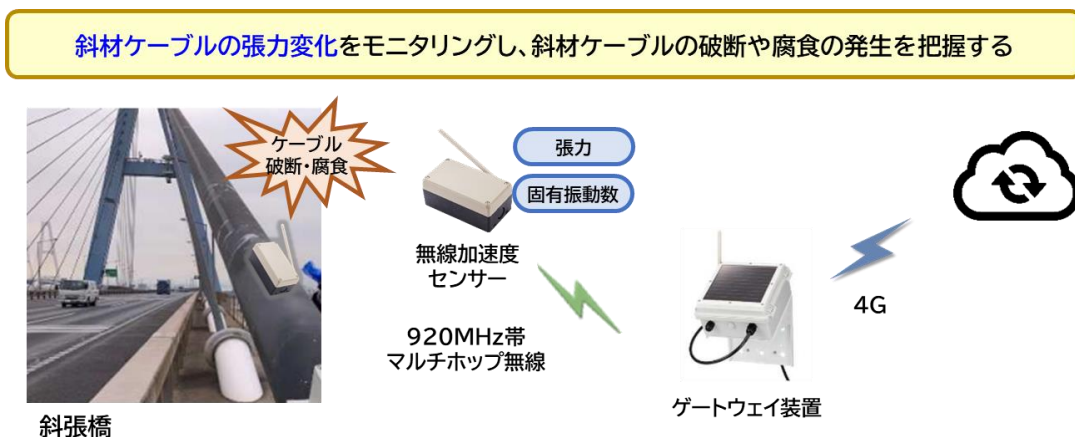
図 2.3-1. 無線加速度センサーによる斜張橋の張力モニタリングの概要
